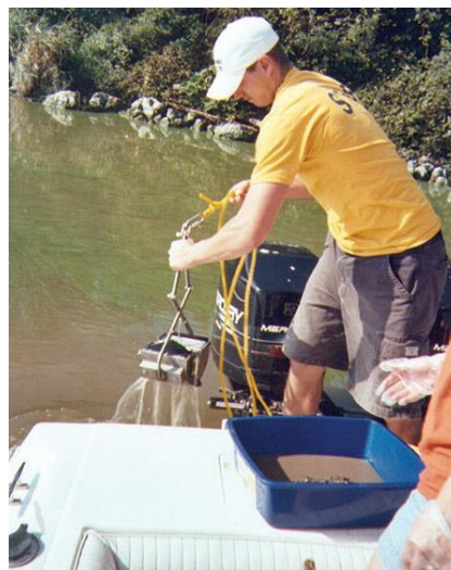
Figure 43: Prélèvement par échantillonneur depuis un bateau (photo John Tertuliani, USGS)
