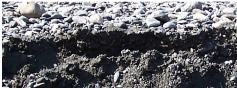
Figure 18: Coupe dans un lit sédimentaire montrant la couche grossière de surface (armure) et les sédiments plus fins situés en dessous
