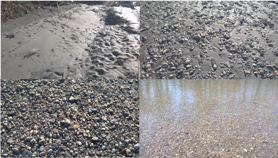
Figure 41: Evolution de la fraction fine sur un même banc de l'Isère observé à des époques différentes, et granulométrie grossière du lit au sein de l'écoulement
