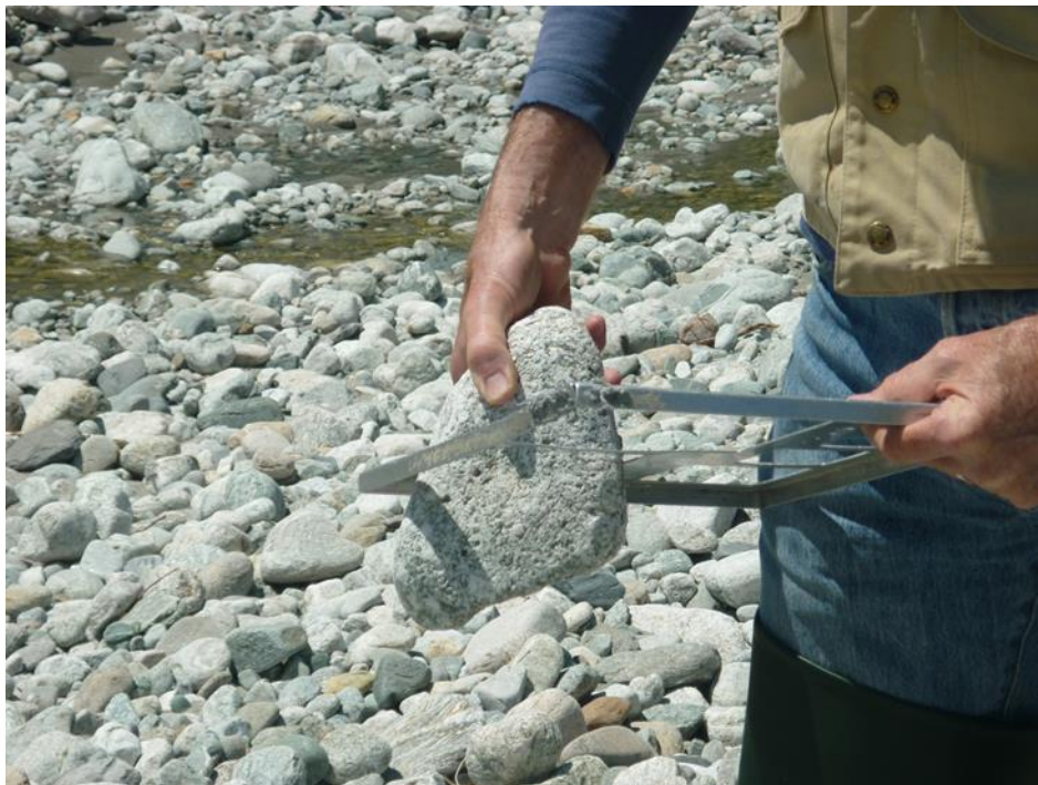
Figure 24: Mesure de l'axe b avec un gabarit
