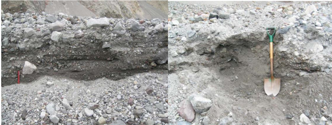
Figure 22: Prélèvement dans un affleurement (sub-surface) pour tamisage
