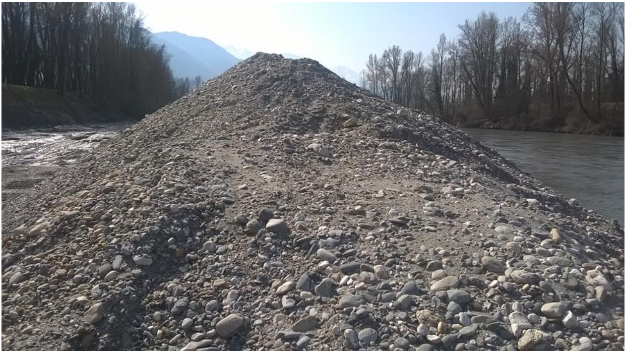
Figure 36: Echantillonner un matériau remanié est très dangereux car il s'y est probablement opéré un tri granulométrique important
