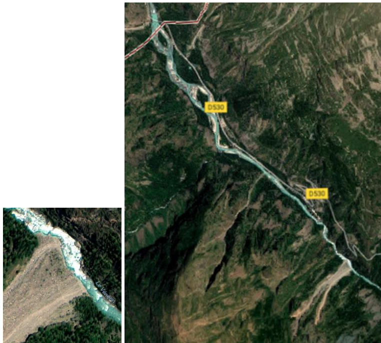
Figure 30: Appoint latéral sur le Vénéon ; la granulométrie du lit en place au droit de l'apport est grossière et il faut dans ce cas se déplacer dans les zones de dépôt, en aval, où ces apports auront refaçoné un lit alluvial (ici une tresse)
